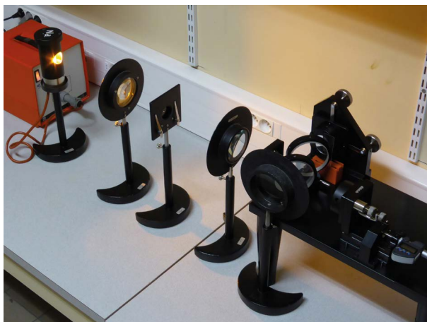
Figure 1 - Dispositif expérimental, utilisant (de gauche à droite) une lampe à vapeur de sodium, un condenseur formant l'image de son ampoule sur un diaphragme à iris servant de sténopé réglable, une lentille collimatrice ( L_C ), l'interféromètre de Michelson avec une lame de verre (juchée sur un support rouge) devant la moitié droite du miroir ( M_2 ) et à peu près parallèle à lui, et à la sortie de l'interféromètre la lentille ( L_S ) de 20 cm de focale comme ( L_C ).
