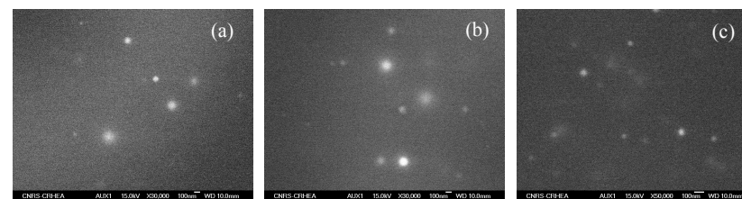
Fig. 1 : Images MEB de coeurs de fibres optiques contenant du Sr (a), Ca (b) et Mg (c), .
