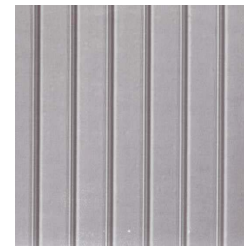
Fig. 3 : Vue de dessus au microscope optique de guides droits en PVCi.
