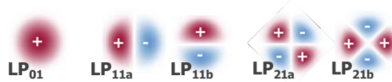
FIGURE 2 : 5 modes spatiaux étudiés : LP01, LP11a et b, LP21 a et b. Les signes + et - symbolisent la phase des lobes d'intensité constituant les modes.
