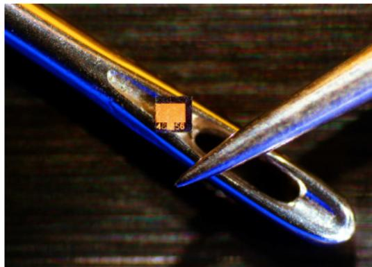
Fig.: Diode Laser sans la
