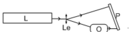
Fig. 2 : montage mono-faisceau par transmission (vue de dessus) composé d'un laser L dont le faisceau collimaté est rendu divergeant à l'aide d'une lentille Le. L'objet O doit être translucide. La partie du faisceau qui traverse l'objet est le faisceau objet alors que celle qui arrive directement sur la plaque P est le faisceau référence.
