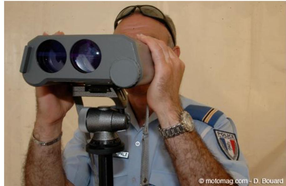
Mesure de la vitesse des véhicules sur route 0 à 250 km/h - Précision : 3%
