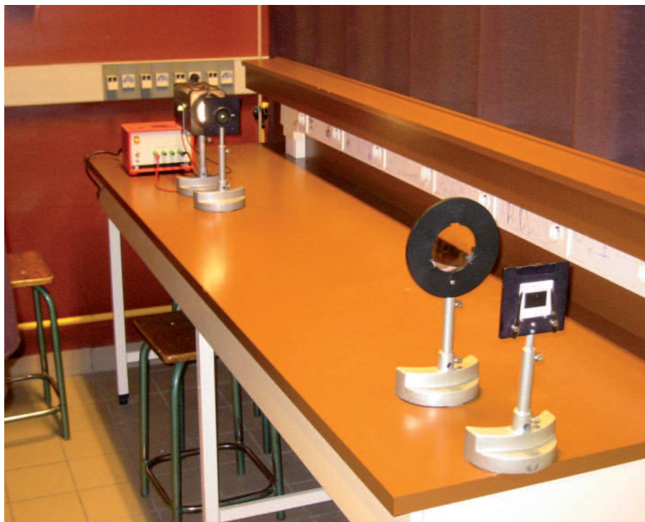
Figure 2 : Montage de RONCHI au lycée ; le trou ( S ) doit être assez petit (sur la photographie, à cause de la profondeur de champ insuffisante, ( S ) paraît bien plus gros qu'il n'était en réalité !).
