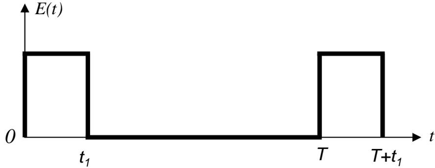
Fig. 5.2: séquence de deux impulsions  $\frac{\pi}{2}$  séparées par un temps  $T$
