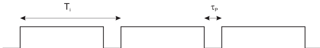
FIG. 6 – Fonction créneau produite par le générateur d'impulsions.
