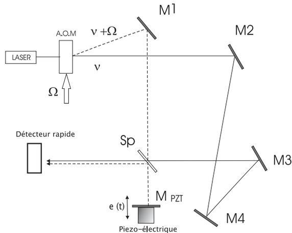
Figure 1: Schéma de principe d'un interféromètre hétérodyne.
